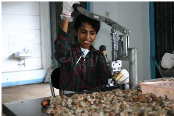
Abbildung 5: Knacken jeder Nuss ohne Hitzezufuhr
